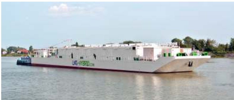
Figura 9. Buque preparado para OPS con generadores de GNL
