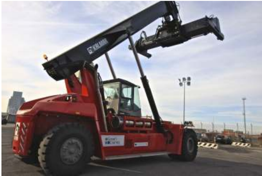
Figura 19. Reachstacker con Sistema de Doble Combustible GNL-Diésel Implementada en Terminal Darsena Toscana, Livorno
