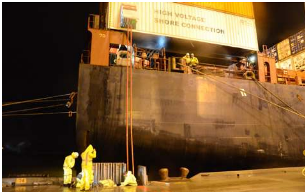
Figura 7. Sistema On Shore Power Supply en el Puerto de Oakland, EEUU
