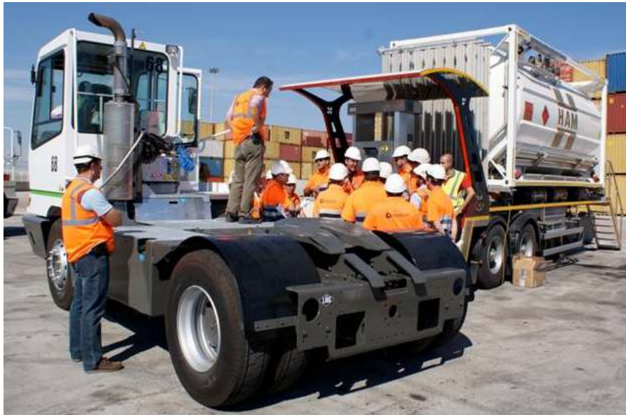
Figura 18. Cabeza Tractora y Camión de suministro de GNL en Noatum Container Terminal Valencia
