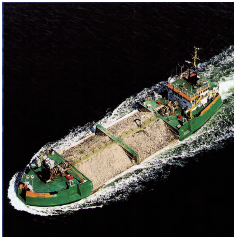
Figura 6.7.3 B Gánguil de vertido lateral
