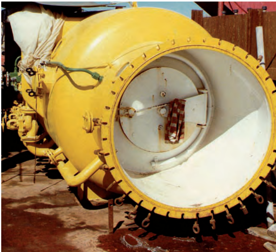
Figura 4.8 Cámara de descompresión
