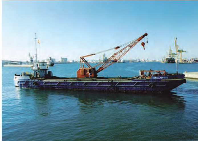
Figura 6.1.3 F Gánguil grúa
