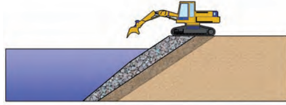
Figura 6.10.2 F Colocación con retroexcavadora segundo manto
