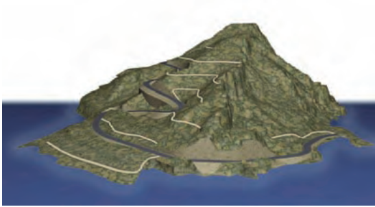
Figura 6.9.3 A Acceso a bancos
