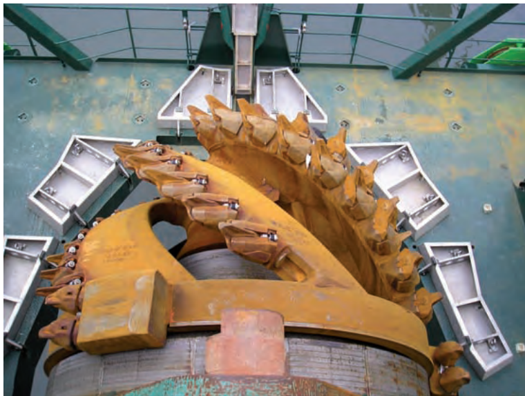
Figura 6.1.3 J Cortador de arcilla dura
