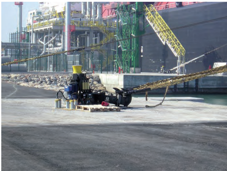
Figura 9.8.3 C Gancho de escape rápido
