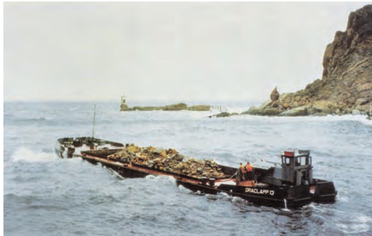
Figura 6.1.3 Q Gánguil con apertura de fondo
