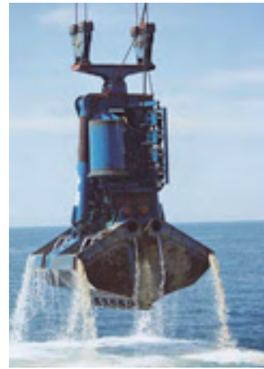
Figura 6.1.3 E Cuchara para arenas y fangos
