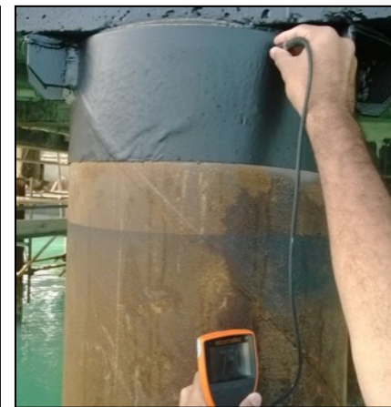
Inspeccion del recubrimiento. Holiday y medicion de espesores de pelicula seca
