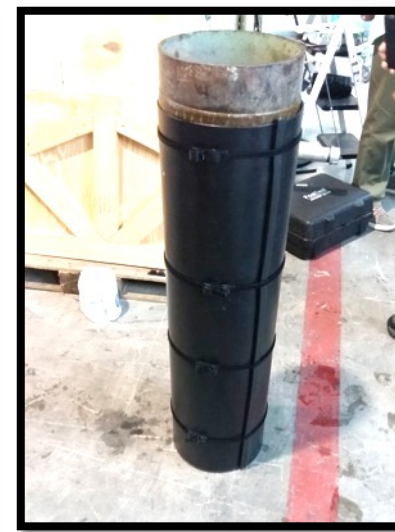
Ajuste de chaqueta usando abrasaderas especiales plasticas.
