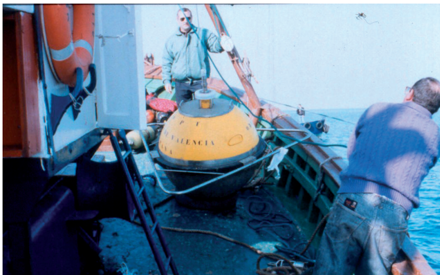
Registrador de oleaje preparado para su fondeo
